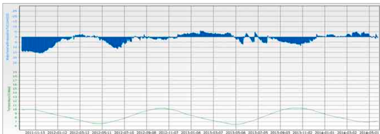
Zmiany poziomu i temperatury wody w torfowisku w latach 2011-2014 w południowej części Torfowiska Karaśniki. Uwodnienie stosunkowo stabilne.
