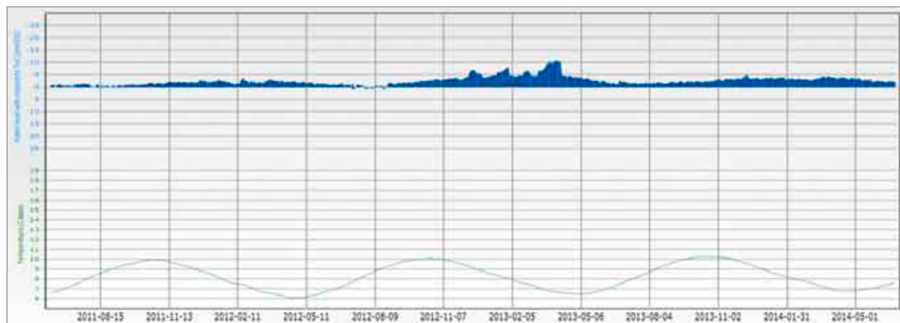
Zmiany poziomu i temperatury wody w torfowisku w latach 2011-2014 w mechowisku na Torfowisku Osowiec.
