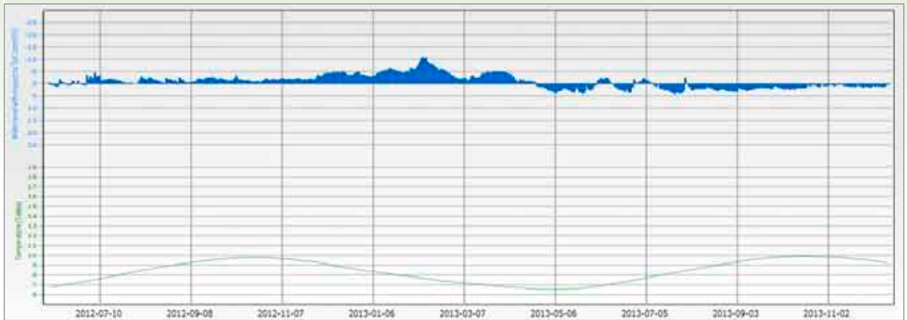
Zmiany poziomu i temperatury wody w torfowisku w latach 2011-2013 na Żółwiej Kłoci.
