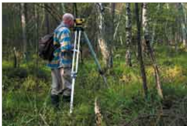
Fot. 58. Pomiary geodezyjne stanowią niezbędny element prac terenowych służących rozpoznaniu topografii torfowiska oraz planowaniu optymalnej liczby i rozmieszczenia przetamowań.
