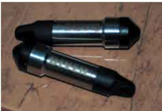
Fot. 73. Automatyczne rejestratory wahań poziomu wody tzw. mikrodivery. Automatic recorders of the water level, so called microdivers.
