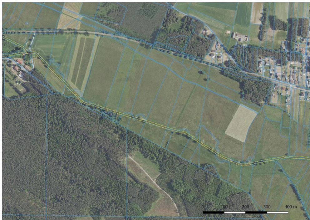
Fot. 74. Sytuacja własnościowa nad Budkowiczanką między ujściem Wiszni a jazem Grzęda, na południowy zachód od Starych Budkowic. Linie niebieskie – granice działek ewidencyjnych, linie żółte – aktualny przebieg koryta rzeki. W tym przypadku możliwe i zasadne jest „przywrócenie rzeki do działek ewidencyjnych”: odtworzenie oryginalnego, meandrującego koryta na tym odcinku
