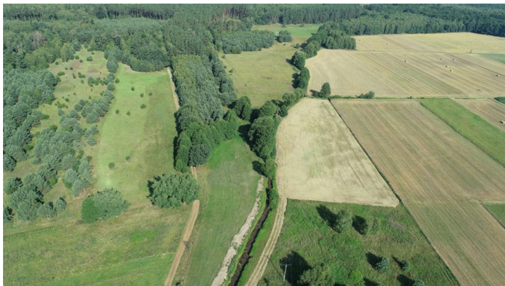
Fot. 55. Bogacica na zachód od mostu w Bukowie – niewłaściwie wykonane prace utrzymaniowe „usuwania roślin korzeniących się w dnie” (osady denne wydobyte i zdeponowane w wał na brzegu). Fot. T. Krzyżków
