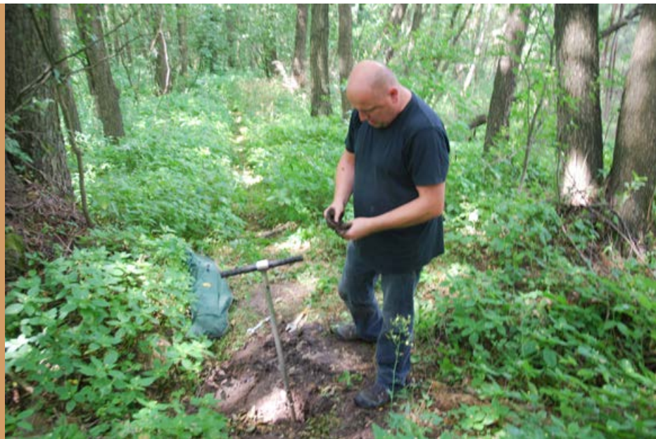
Rezerwat „Bagno Mostki” - Robert Stańko wykonujący odwierty na grobli oddzielającej dwie części torfowiska, aby ustalić przyczyny zaburzeń w warunkach hydrologicznych rezerwatu. Fot. Karolina Banaszak
